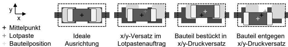
Bild 69: Untersuchte Kombinationen aus Versatz der gedruckten Lotpaste und der bestückten Bauelemente der Größe 01005
