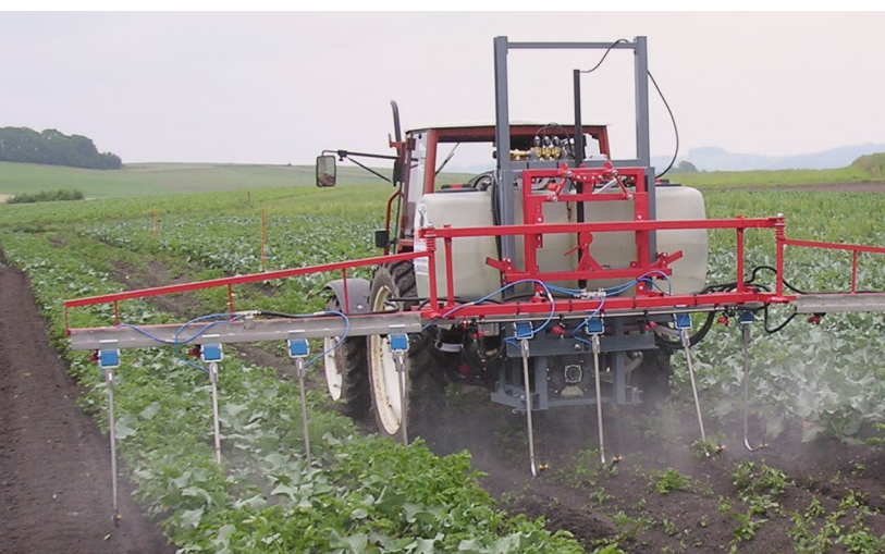
Droplegs bringen die Spritzbrühe an die Blattunterseiten, wo sich einige Schädlinge wie Blattläuse gerne aufhalten.
