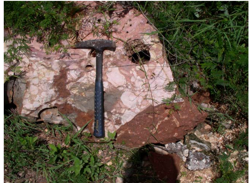
Caliza Pedernales, compuesta de clastos (restos de roca) angulosos y redondeados (de tamaño centimétrico) en matriz rosada, karstificada (agujero arriba), presentando un manto de alteritas (Foto y descripción: J. Martínez)
