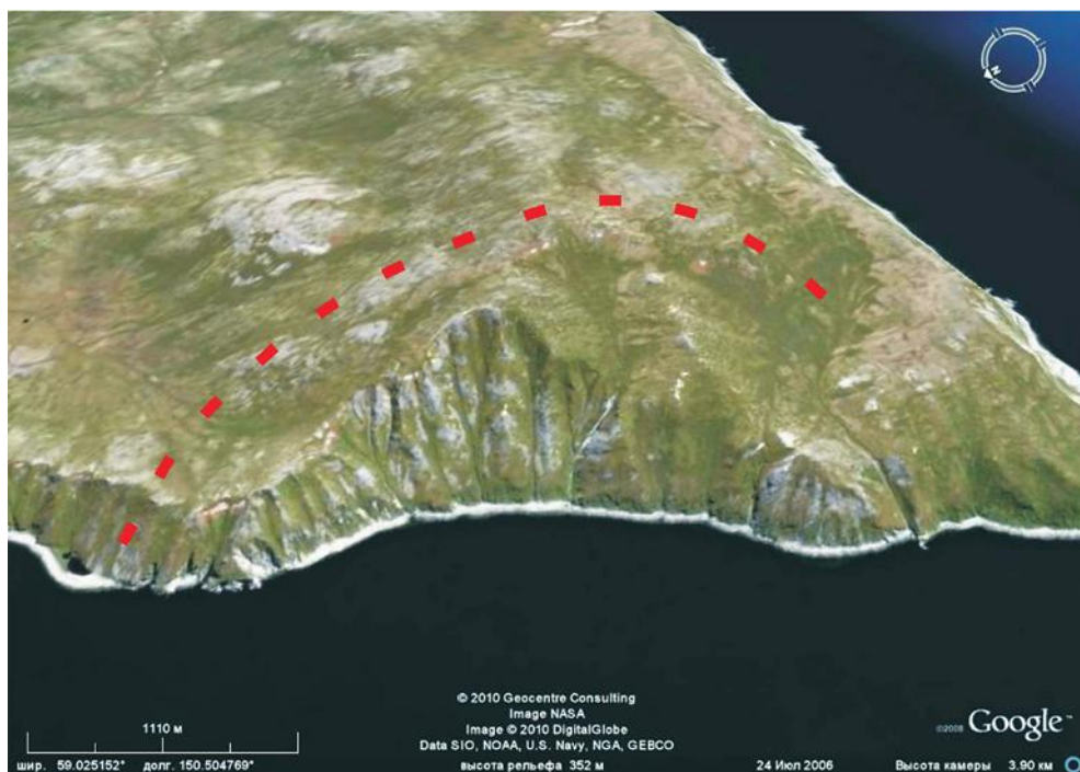
Рис. 1.23. Предполагаемый глубинный скальный оползень у м. Южный
