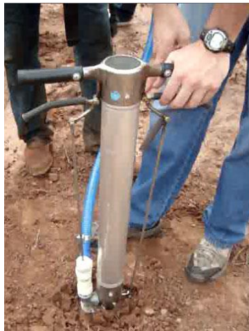
Figura 3. Plantadeira manual com aplicador de hidrogel acoplado. Fonte: Sanches, 2013.
