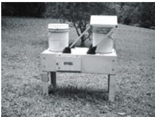
Figura 1. Coletor automático de deposição úmida e seca instalado próximo à sede do Parque Nacional da Serra dos Órgãos, em Teresópolis.
