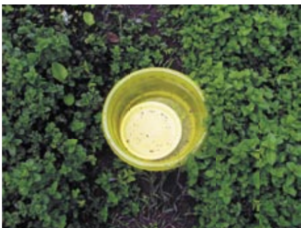
Fig. 2. Armadilhas de Mörické junto ao solo.
