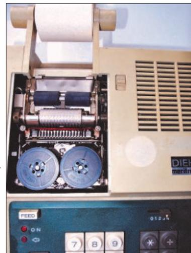
**Ricoh-Druckwerk in der Diehl-Meritronic** - rotierende Drucktrommel - vor dem Farbband liegen elektromagnetisch gesteuerte Hämmerchen, die taktgerecht nach vorn schnellen und für den Abdruck sorgen.
