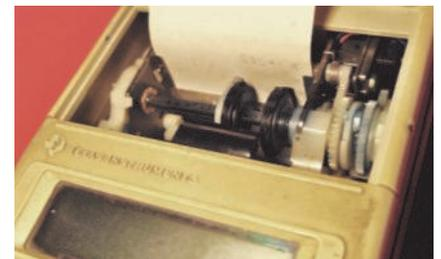
Das kleine Druckwerk wird per Seilzug bewegt. Einfärbung durch Kissen.
