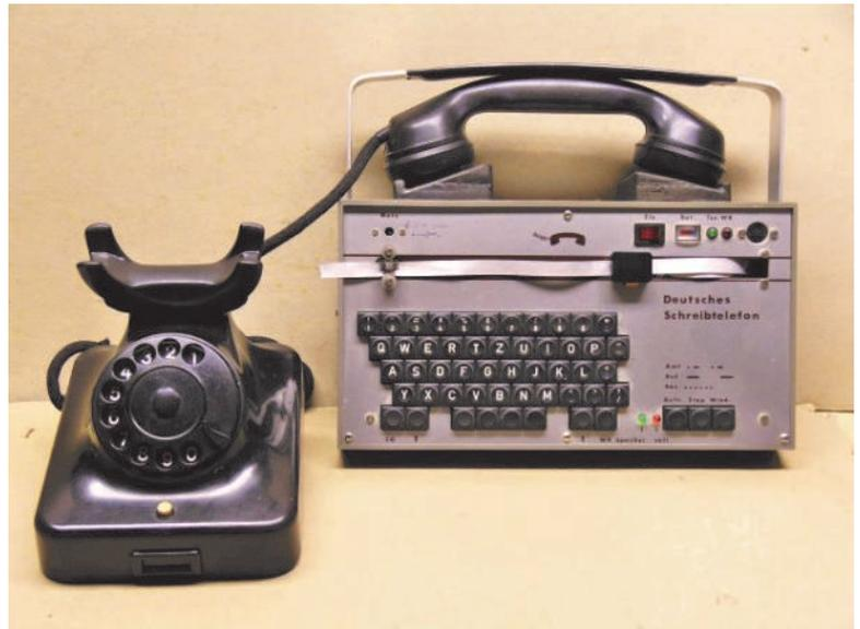
„Deutsches Schreibtelefon“ von HGT mit Tastatur, Thermostreifen-drucker und Akustikkoppler als Verbindung zum Telefonnetz. Ablauf: erst schreiben, dann verbinden, dann senden. Statt der Buchstaben sendet das Gerät codierte Frequenzen („Piepstöne“).
