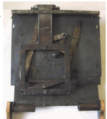
**Bild 2** Vor der Restauration: Unterseite des aufgeklappten Schlittenoberteils. Man erkennt den Rahmen des Gummi-Typenträgers und die Hebelmechanik
