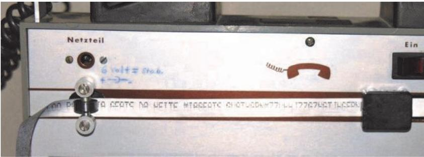
**Kontrollstreifen auf Thermo-Druckpapier. Rechts ist der kleine schwarze Kasten zu erkennen, in dem feine Kontakte Funken erzeugen, deren Wärme das Papier schwarz werden lässt.**
