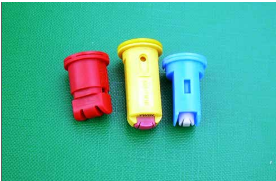
Fot. 81. Rozpylacze dwustrumieniowe eżektorowe w wersji z symetrycznymi wachlarzami (najczęściej tworzą względem siebie kąt 60^\circ – jak na zdjęciu) (fot. R. Kierzek)
