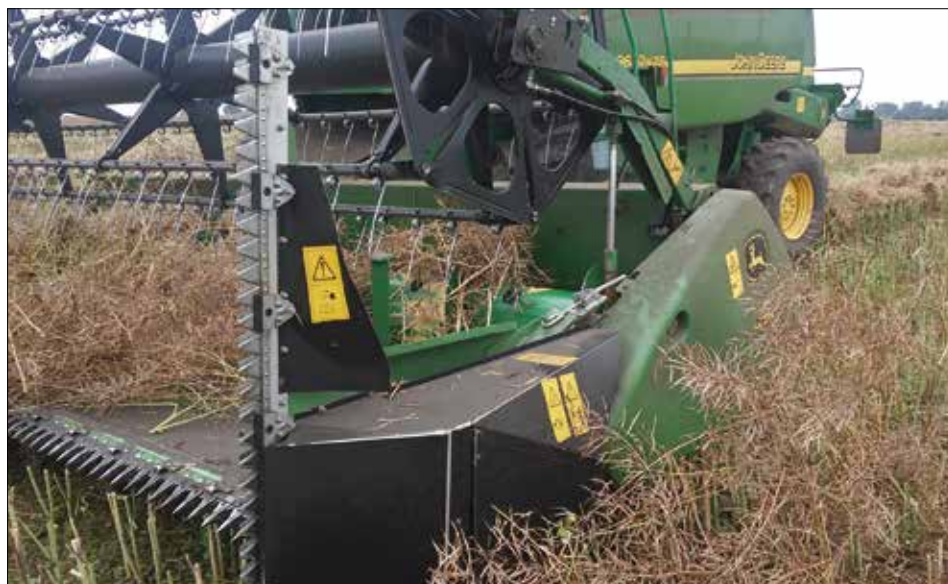
Fot. 79. Zespół żniwny John Deere 625R z wydłużoną podłogą i aktywnymi rozdzielaczami łań (fot. J. Przybył)
