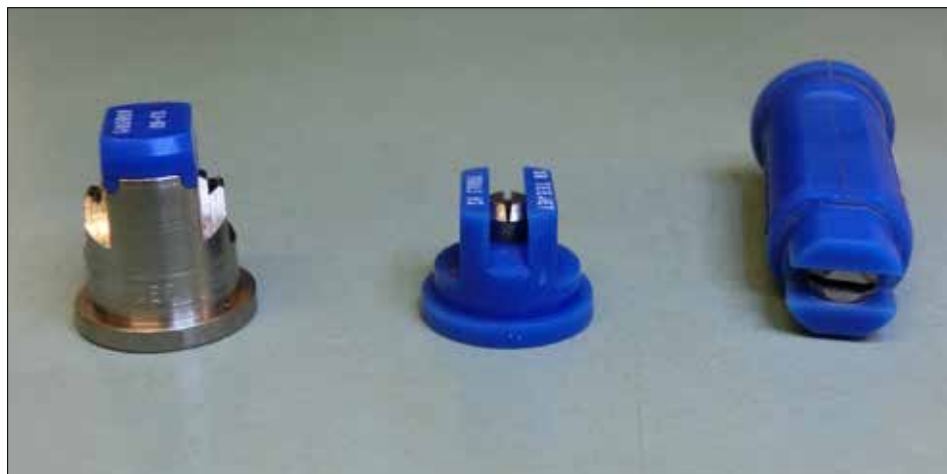
Fot. 80. Wielkość kropli wytwarzana przez rozpylacz o płaskim strumieniu zależy od jego konstrukcji. Przy tym samym wydatku i pod ciśnieniem 0,3 MPa rozpylacze przedstawione na zdjęciu klasyfikowane są następująco: bardzo drobnokroplisty – klasyczny rozpylacz dwustrumieniowy (po lewej), drobnokroplisty – standardowy rozpylacz jednostrumieniowy (w środku), bardzo grubokroplisty – rozpylacz eżektorowy (po prawej) (fot. H. Ratajkiewicz)
