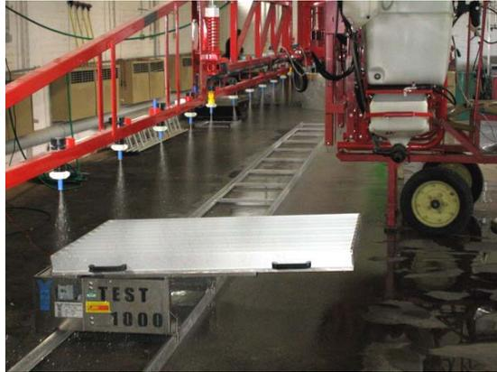
Abb. 1: Prüfstand für Flächensprühgeräte
