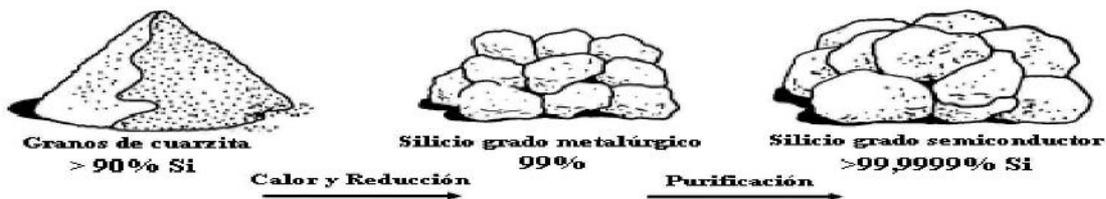
Una vez obtenido este silicio puro, se pasa a fabricar las celdas solares de Silicio a base de dopar las obleas obtenidas a base de Silicio puro con átomos de Fósforo en un horno a temperaturas entre 800° y 900° C para obtener la capa N.
