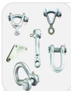
Herrajes: (Grillete normal, Horquilla Bola, Horquilla revirada, Rotula Horquilla, Anilla Bola, Yugo triangular, yugo separador) de acero forjado y convenientemente galvanizados en caliente para su exposición a la intemperie, de acuerdo con la Norma UNE 21158.
