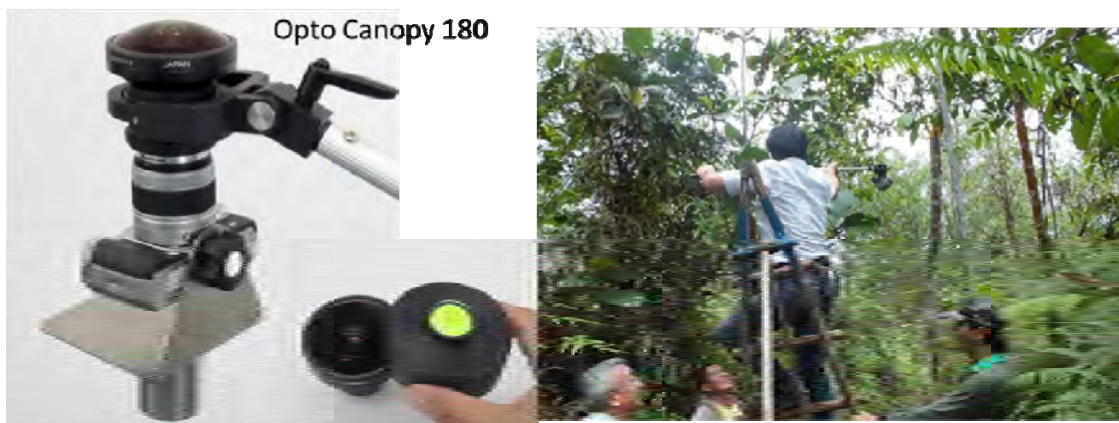
図-4 フィット社の魚眼レンズ(UWC1990)とカメラ(ニコン CoolPix7800)と水平撮影装置(Opto Canopy)
