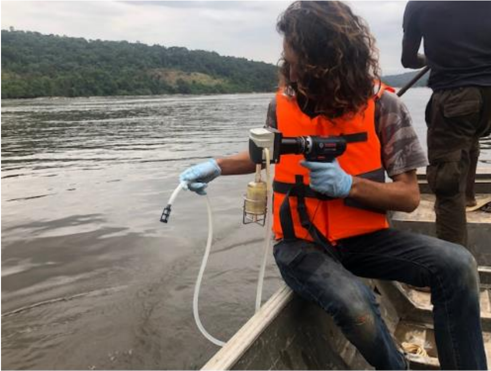
Figure 23 : Prélèvement d'échantillons d'eau pour les analyses ADNe à l'aide d'une pompe dédiée et des capsules de filtration
