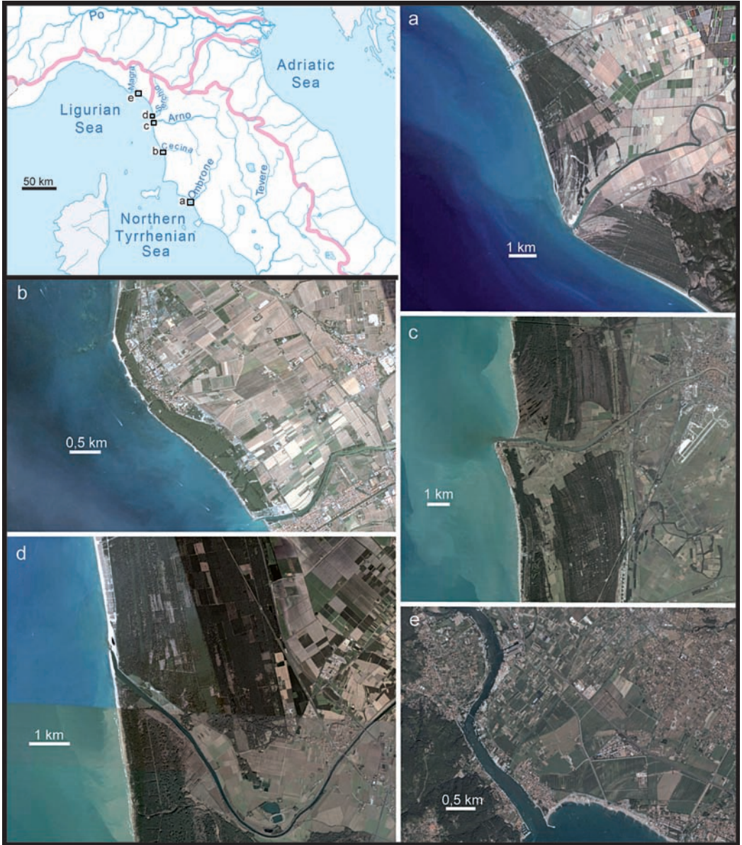
Figura 2: Localizzazione e tipi di foce di alcuni fiumi toscani: (a) delta cuspidato del fiume Ombrone [6]; (b) estuario del fiume Cecina; (c) delta cuspidato del fiume Arno [6]; (d) estuario del Fiume Serchio; (e) estuario del fiume Magra.
