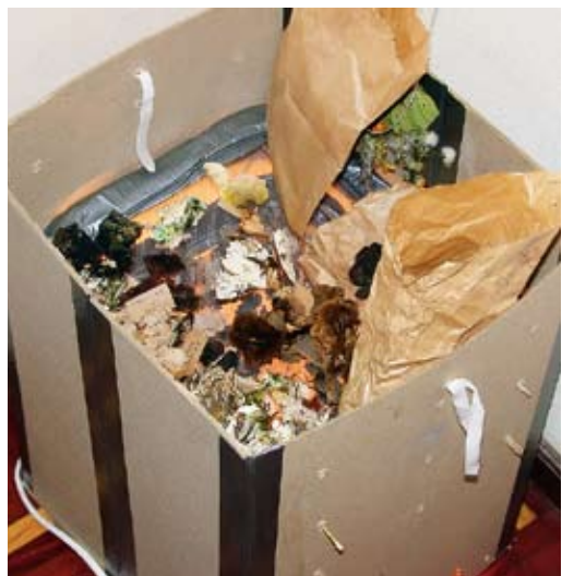
Det hjemmelavede felt-tørreapparat, der blev lavet af tykt pap og gaffatape – i bunden en lyspære som varmekilde.
