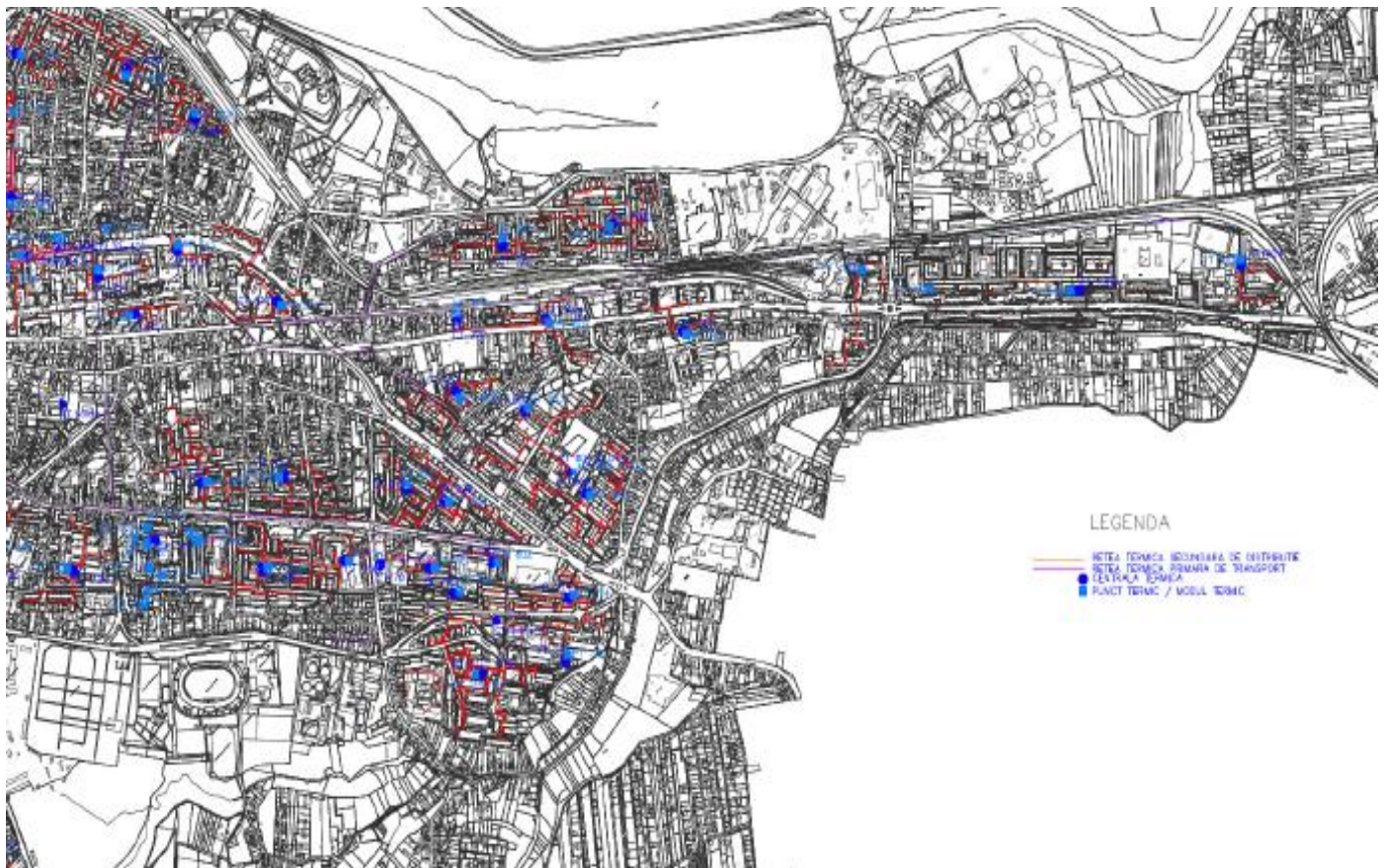
Fig. 6.20. Plan amplasament o parte din rețelele și sursele de producere SACET Pitești 233
