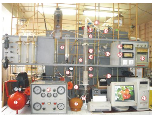
Фиг. 1. Лабораторна инсталация за пиролиз на оризови люспи с реактор тип „кипящ“ слой.
