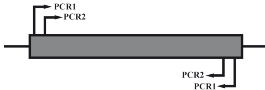
Abb. 4: Schema der Oligonukleotid-Bindestellen bei einer Nested PCR
