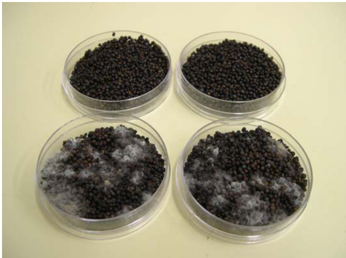
Fig.6.6: Diferència en el grau de contaminació de llavors de colza (no colonitzades amb P. eryngii ) exposades en un entorn no estèril durant 7 dies, segons si han estat recobertes amb (sobre) o sense (sota) pintura acrílica.
