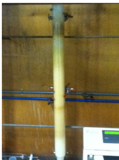
Figura 4. Coluna cromatográfica clássica Sephadex LH20 em fase de separação das frações. Fonte: Arquivo pessoal
