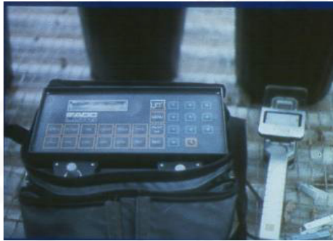
Figura 1. Un analizador de gases infrarrojo portátil para medir la fotosíntesis, transpiración, conductancia estomatal, y contenido interno de \text{CO}_2 en las plantas.
