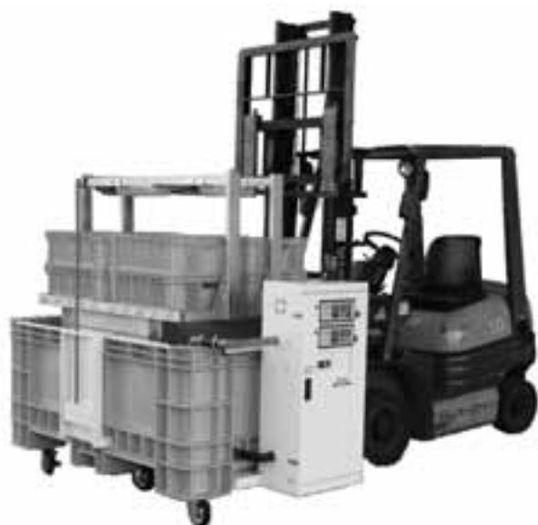
図4 開発したコンニャク種いも温湯消毒装置（商品名：こんにゃく工房、(株)タイガーカワシマ製）
