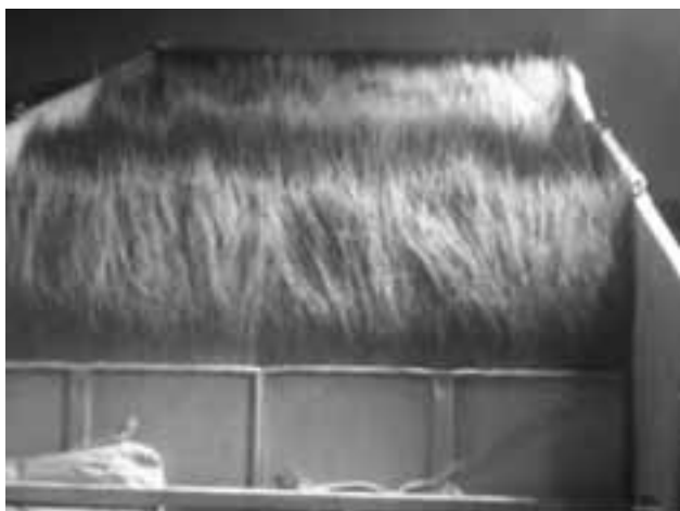
写真10 いぐさ乾燥機と乾燥中のいぐさ (泥染めしたいぐさは乾燥機に立て均一に詰めることが重要)
