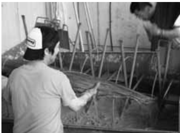
写真9 いぐさの泥染め作業 (染土液にいぐさを浸して行う。)
