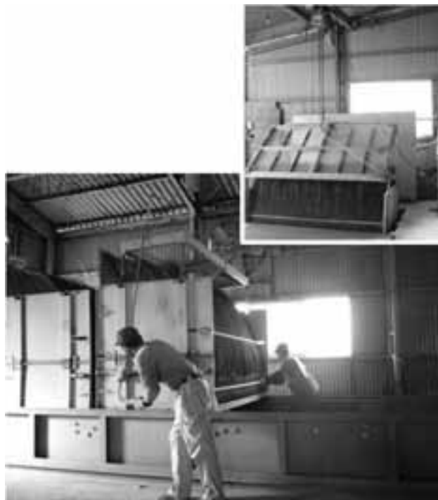
写真11 コンテナで泥染めから乾燥までを処理する大型乾燥機(システム乾燥機) (上：地下に掘った水槽で泥染めを行う) (下：コンテナを連結して乾燥する)
