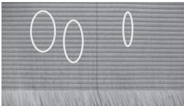
写真2 畳表の比較 (「岡山3号」(左)「涼風」(右)) (畳表の表面に若干の変色茎(写真中の○)が見えるが、「岡山3号」よりも少ない。)
