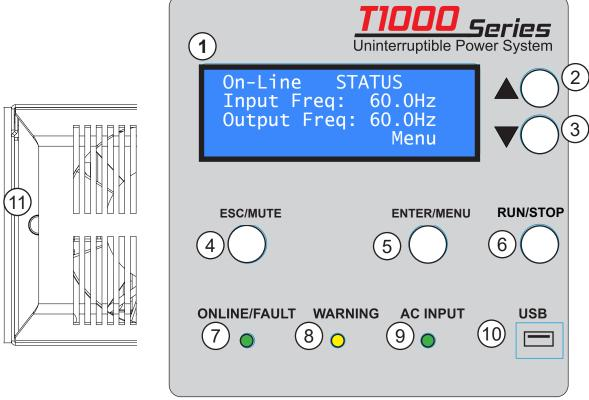
**FIGURE 9.1: FRONT PANEL LAYOUT**
