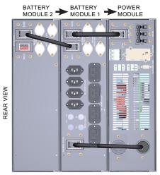
FIGURE 6.3: TOWER 240V<sub>OUT</sub> SYSTEM WITH OUTLET PANEL
