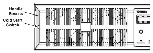
FIGURE 14.1: COLD START SWITCH LOCATION
