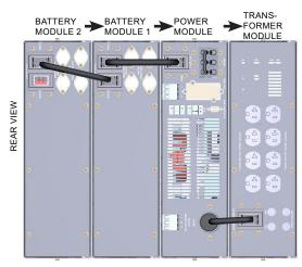
FIGURE 6.4: TOWER 120V  $_{\rm OUT}$  SYSTEM WITH TRANSFORMER MODULE
