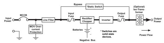
FIGURE 12.2: POWER FLOW IN ONLINE MODE FOR ALL MODELS
