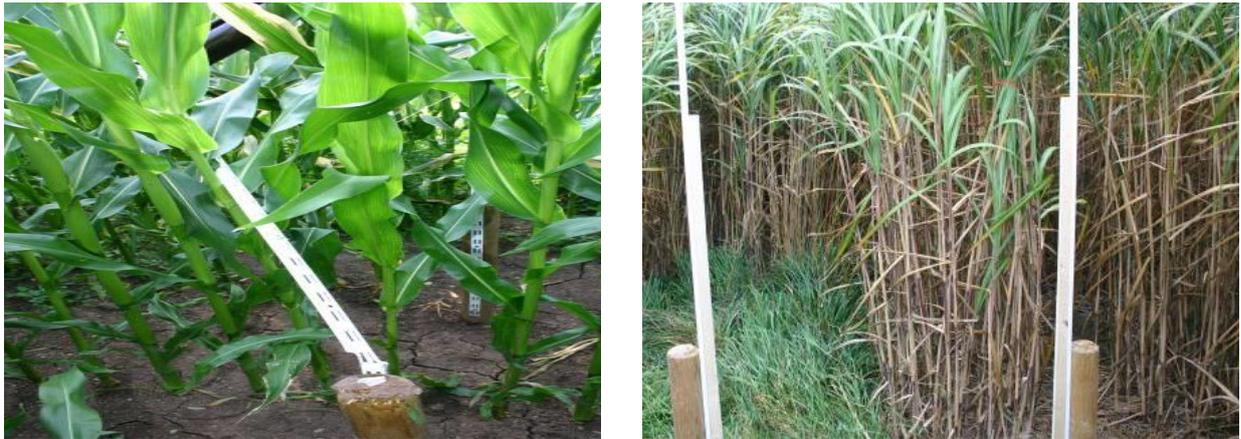
Abbildung 4.7: Probleme bei Fensterfallen - links: Umgeknickte Fensterfalle (Schwachstelle zwischen Holzpflock und Metallschienen); rechts: Reparierte Fensterfalle im Miscanthus. Verstärkung der Metallschienen durch Holzplatten
