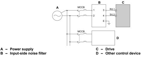
Figure 8.5 Input-Side Noise Filter (Single-Phase 200 V)
