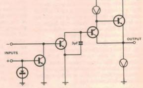
FIG. 1 BASIC OPERATIONAL AMPLIFIER
