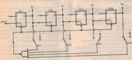
FIG. 4 ADJUSTABLE MODULO COUNTER (SET FOR MODULO-11)
