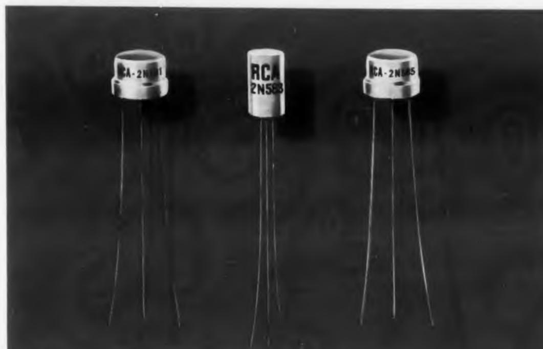
**NEW GERMANIUM ALLOY-JUNCTION TRANSISTORS FOR
