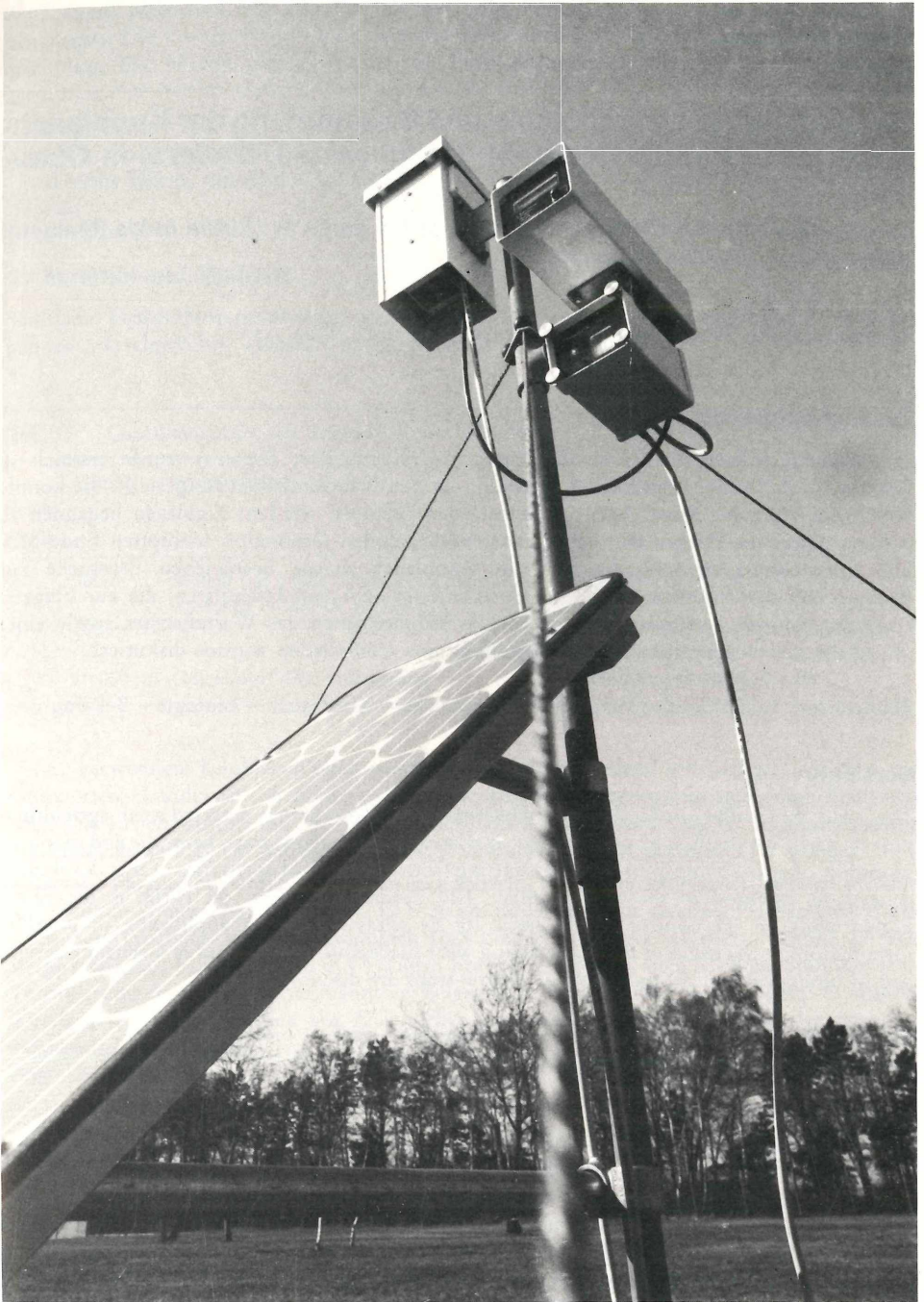
Abb. Warngerät „Meteodat-L®“ bestehend aus Kleinwetterhütte, Recheneinheit, Drucker und Solarpaneel.
