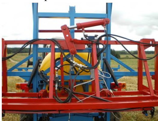
Рисунок 4 - Узлы системы СМАР после установки на опрыскивателе [4]
